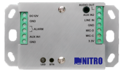
GS-AID II声强探测处理器 安装于自助银行天花板，用于环境声强的探测与分析。
